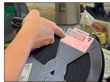
Mit einem Datenscanner kann die individuelle Kennziffer jedes Bauteils überprüft werden.
